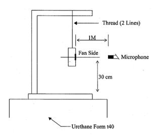
1 METER FROM MICROPHONE TO FAN INTAKE
