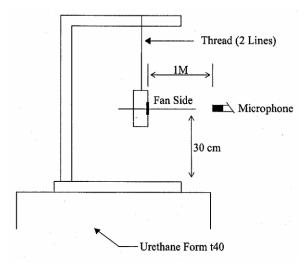
1 METER FROM MICROPHONE TO FAN INTAKE
