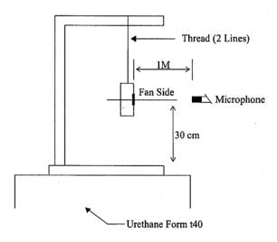
1 METER FROM MICROPHONE TO FAN INTAKE
