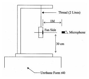
1 METER FROM MICROPHONE TO FAN INTAKE
